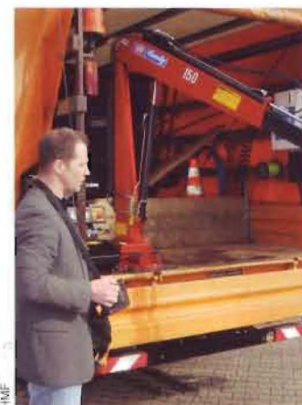
Effektiv lassen sich Hebe- und Arbeitsaufgaben mit einer für fast alle HMF-Handymodelle (hier HMF „150“) erhältlichen Funkfernsteuerung gestalten.
